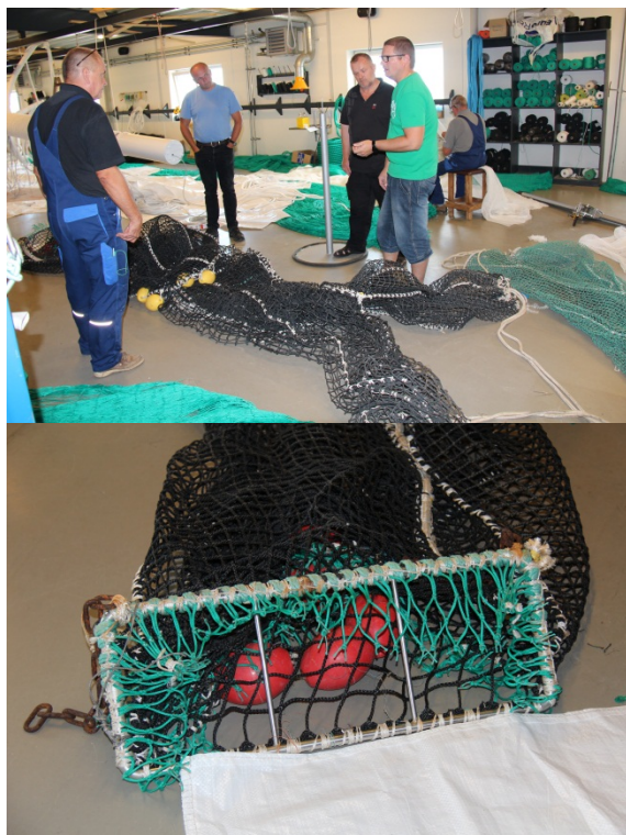
Figur 3. Udvikling og produktion af den horisontaldelte fangstpose i samarbejde med vodbinder og fiskeskipper (venstre). Skematisk illustration af standardposen og det endelige design på den horisontaldelte (eksperimentelle) fangstpose.
