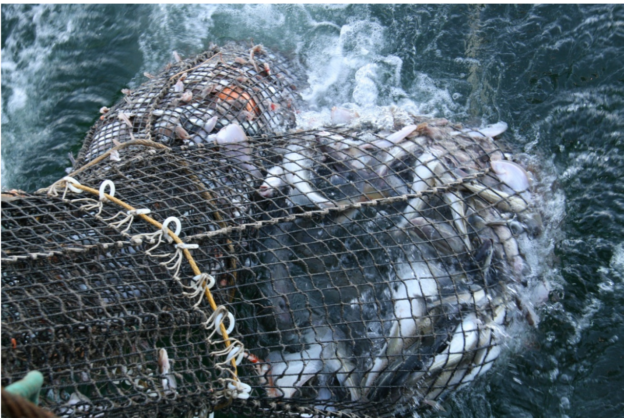
Figur 25. Den horisontaldelte fangstpose med 120 mm kvadratmasker i fiskeposen og 60 mm kvadratmasker i hummerposen.
